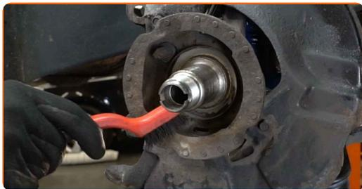
**20** Instale o novo cubo da roda com um rolamento. Use uma chave soquete nº 46. Use um martelo.
