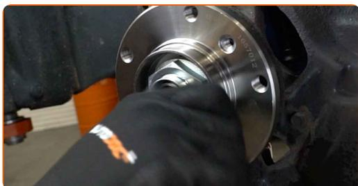
**22** Aperte a porca do cubo de roda. Use uma chave soquete nº 46. Use uma chave de torque. Aperte-o para o torque de 290 Nm.
