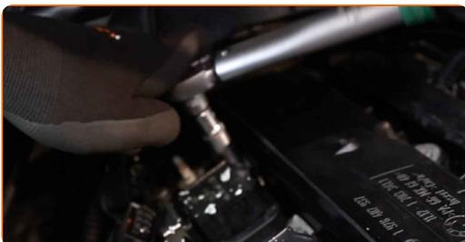
22 Trate o conector da bobina de ignição com spray eletrónico.
