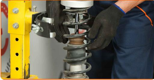
36 Retire a coluna de suspensão montada.
