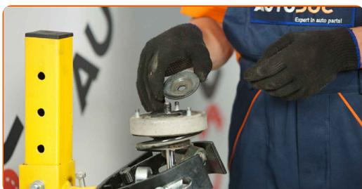
Substituição: cabeçotes do amortecedores – BMW 7 (E65, E66, E67).
