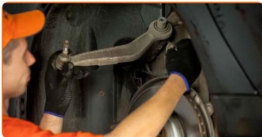
**15** Limpe os locais de montagem e a rosca do braço da suspensão. Use uma escova metálica. Use spray WD-40.
