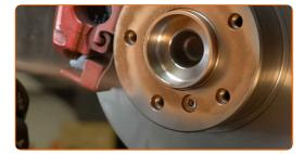
Limpe a superfície do disco de travão. Utilize um produto de limpeza para travões.
