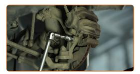
Retire os parafusos de fixação (2 peças).
