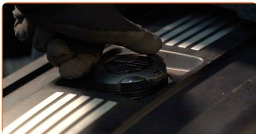
**4** Desaperte a tampa da caixa do filtro em conjunto com o antigo elemento do filtro. Use o soquete 86-16F. Use uma chave de catraca.
