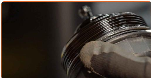
**22** Retire anéis em O antigos da tampa do filtro de óleo. Use uma chave de fenda plana.
