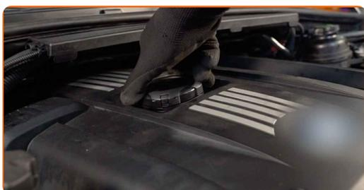
**33** Ligue o motor por alguns minutos. Após a luz de advertência da pressão do óleo se apagar, desligue o motor.
