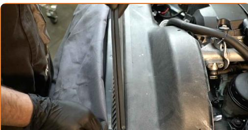
5 Desenrosque e retire a embraiagem viscosa do ventilador.
