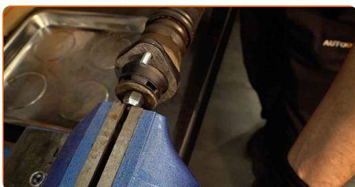
23 Aperte a fixação superior da haste do amortecedor. Use uma chave combinada nº 17. Use uma chave inglesa. Use uma chave de torque. Aperte-o para o torque de 20 Nm.
