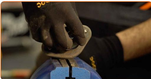
20 Remova o suporte do amortecedor, a coifa e o batente de encosto do amortecedor.
