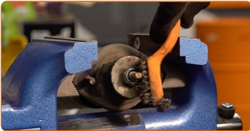
18 Retire a fixação da haste do pistão do amortecedor. Use uma chave combinada nº 17.
