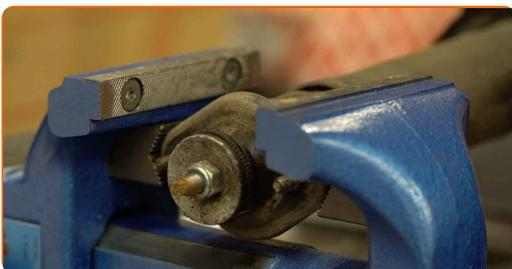
17 Limpe o elemento de fixação de componentes do amortecedor. Use uma escova metálica.
