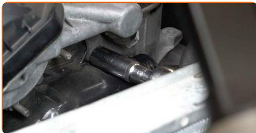
**15** Desparafuse os fixadores da carcaça do termóstato. Use uma chave soquete nº 10. Use uma chave de catraca.
