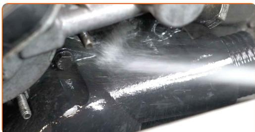
**17** Desparafuse os fixadores da carcaça do termóstato. Use uma chave soquete nº 10. Use uma chave de catraca.
