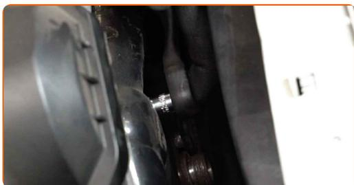
**16** Limpe os fixadores da carcaça do termóstato. Use o spray de limpeza universal.
