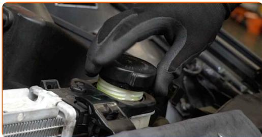
**39** Enrosque a tampa do depósito do líquido de refrigeração.
