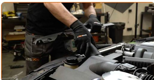
**5** Desenrosque a tampa do depósito do líquido de refrigeração.
