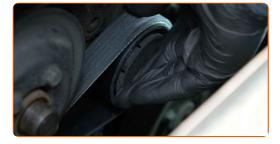
Instale a correia do compressor do ar condicionado.
