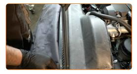
Desenrosque e retire a embraiagem viscosa do ventilador.
