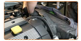
Aperte o parafuso de fixação da embraiagem viscosa do ventilador. Use uma chave combinada nº 32. Use uma chave de torque. Aperte-o para o torque de 40 Nm.
