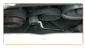
Remova a correia do compressor do ar condicionado.
