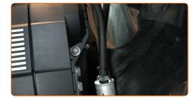
20 Instale e aparafuse a embraiagem viscosa do ventilador.
