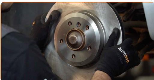
**21** Aperte a fixação do disco de travão. Use Torx T30. Use uma chave de torque. Aperte-o para o torque de 16 Nm.
