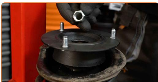
**27** Aperte a porca do suporte do amortecedor da haste do pistão. Use uma chave soquete nº 19. Use uma chave soquete nº 9. Use uma chave de torque. Aperte-o para o torque de 52 Nm.
