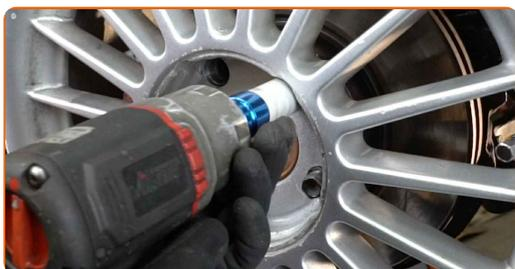
**48** Baixar o carro e trabalhar em ordem transversal, apertar os parafusos das rodas. Use o soquete de impacto para roda #17. Use uma chave de torque. Aperte-o para o torque de 120 Nm.
