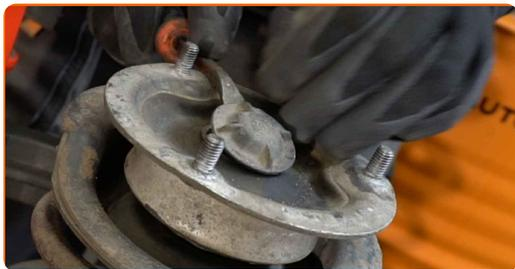
**22** Trate a haste da coluna do amortecedor. Use uma escova metálica. Use spray WD-40.
