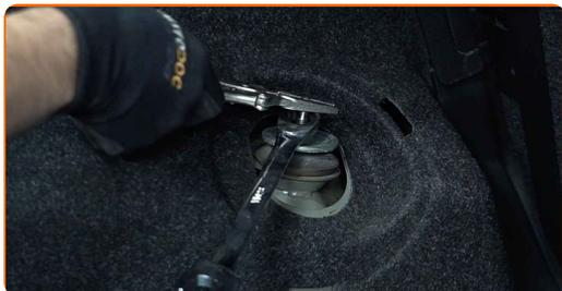
**13** Remova o parafuso de fixação. Use uma chave soquete nº 19.
