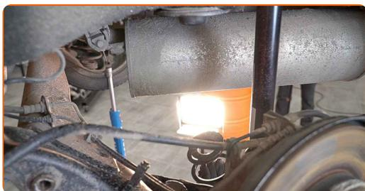
**17** Instale o compressor de mola em conjunto com os suportes de borracha nos locais de montagem.
