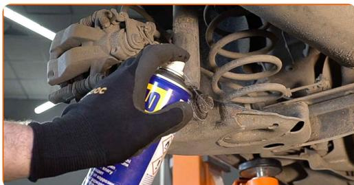
**8** Desaperte a fixação inferior do amortecedor. Use uma chave soquete nº 19. Use uma chave de tarraxa.
