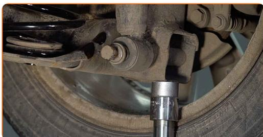
**19** Aparafuse o fixador inferior do amortecedor. Use uma chave soquete nº 19.
