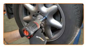
Baixar o carro e trabalhar em ordem transversal, apertar os parafusos das rodas. Use o soquete de impacto para roda #17. Use uma chave de torque. Aperte-o para o torque de 110 Nm.
