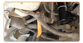
Desaparafuse o fixador que conecta a bieleta da barra estabilizadora à coluna do amortecedor. Use uma chave soquete nº 16. Use uma chave de catraca.
