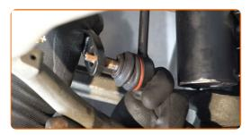
Desaparafuse o fixador que conecta bieleta da barra estabilizadora à barra estabilizadora. Use uma chave soquete nº 17. Use uma chave de torque. Aperte-o para o torque de 60 Nm.
