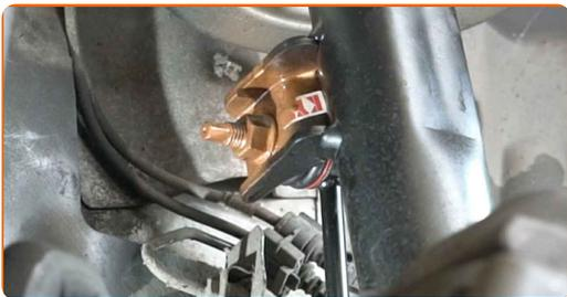
**64** Trate os fixadores do amortecedor. Use massa de cobre.
