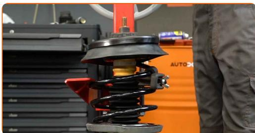
**43** Retire a coluna de suspensão montada.
