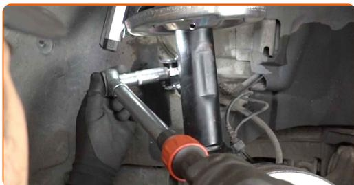
**63** Trate todas as juntas de conexão do estabilizador.
