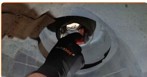
**45** Instale o amortecedor no arco da roda.
