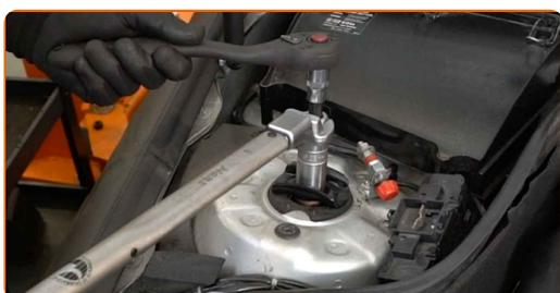
**72** Trate os fixadores do apoio da coluna de suspensão. Use massa de cobre.
