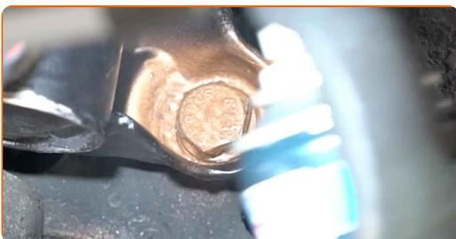
**65** Trate a superfície onde o disco de travão entra em contacto com o aro da roda. Use massa de cobre.
