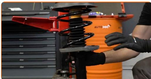
**44** Trate dos assentos de montagem do amortecedor. Use uma escova metálica. Use spray WD-40.
