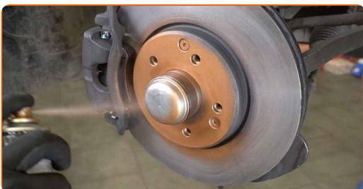
**66** Limpe a superfície do disco de travão. Utilize um produto de limpeza para travões.
