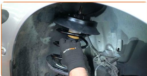
**46** Aparafuse a fixação superior de montagem do suporte do amortecedor. Não o aperte.
