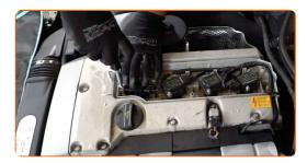
Ligue o conector da bobina de ignição.
