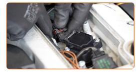
Instale a tampa do motor e fixe-a. Use HEX n.º HW5.
