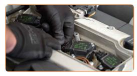
Desaperte o suporte da bobina de ignição. Use uma chave soquete nº E8.
