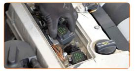
Trate a ponta da bobina de ignição. Use massa de alta temperatura. Use uma chave de fenda plana.
