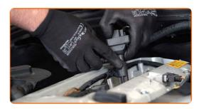
Apertar a fixação da bobina de ignição. Use uma chave soquete nº E8. Use uma chave de torque. Aperte-o para o torque de 9 Nm.
