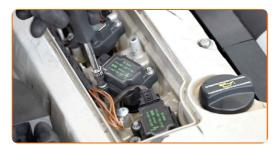
Retire a bobina de ignição do orifício da vela de ignição.
