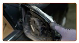
Volte a encaixe as abas do repetidor de luz indicadora de mudança de direção na carcaça do espelho. Certifiquese que ouve um clique a indicar que está fixa no local.
