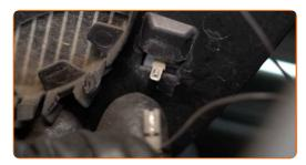
Desaparafuse os fixadores da carcaça do espelho. Use Torx T10.
