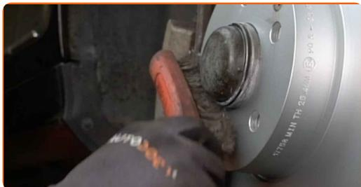
**25** Trate a superfície onde o disco de travão entra em contacto com o aro da roda. Utilize massa lubrificante de cerâmica.
