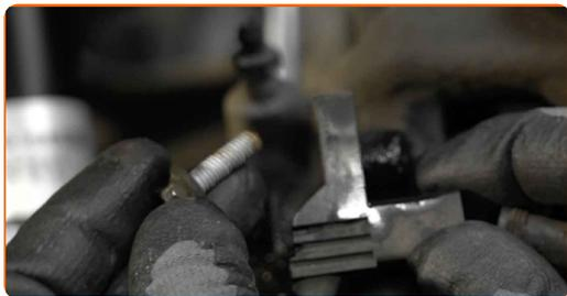
**11** Desprenda a cablagem do sensor de desgaste da pastilha de travão.
