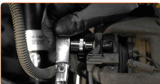
**10** Remova o parafuso de fixação.
