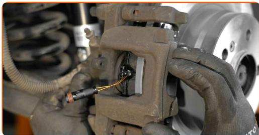
**25** Aperte os fixadores da pinça do travão. Use HEX n.º H7. Use uma chave de torque. Aperte-o para o torque de 25 Nm.
