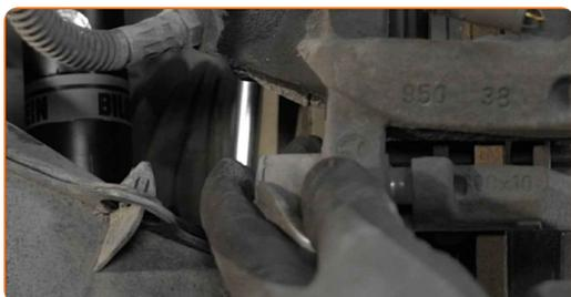
**14** Desaperte os parafusos da pinça de travão. Use HEX n.º H7. Use uma chave de catraca.
