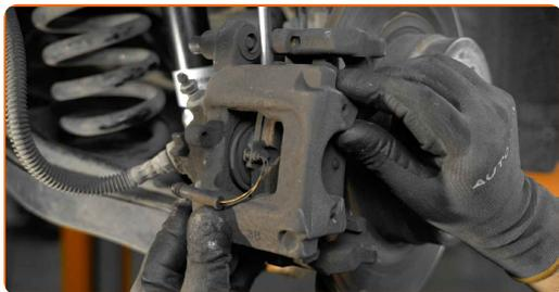
**Substituição: sensor pastilha de freio – Mercedes W204. Conselho:**
