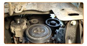
Substituição: correia trapezoidal estriada – Opel Corsa C. AUTODOC recomenda:
