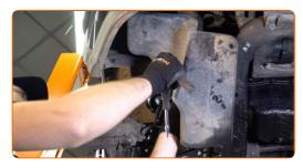
Instale e aperte os elementos de fixação da cobertura do arco da roda. Use Torx T20.
