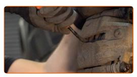
Desaparafuse a fixação de pinça de travão. Use uma chave soquete nº 12. Use uma chave de catraca.
