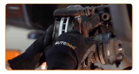
Substituição: pastilhas de travão – Opel Corsa C. AUTODOC recomenda:
