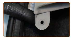
Solte o anel de retenção que liga o amortecedor a gás à carroçaria do automóvel. Use uma chave de fenda plana.
