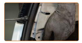
Instale o novo amortecedor de gás da tampa da bagageira.
