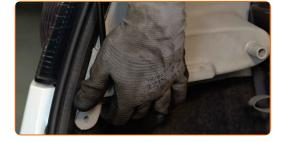
Encaixe o anel de retenção que liga o amortecedor à tampa da bagageira.
