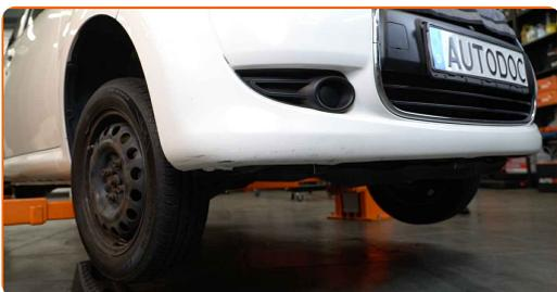
**5** Desaperte os parafusos da roda.
