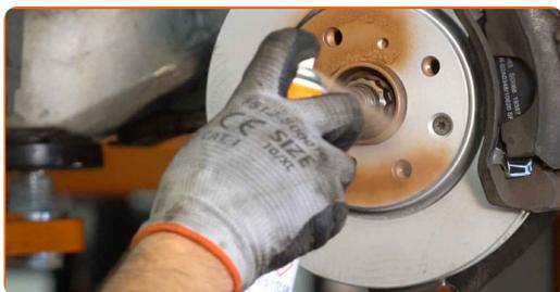
**80** Limpe a superfície do disco de travão. Utilize um produto de limpeza para travões.
