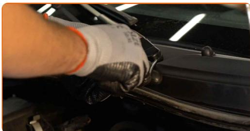
**4** Desaperte os fixadores dos braços do limpa vidros do para-brisas. Use uma chave soquete nº 12. Use uma chave de catraca.
