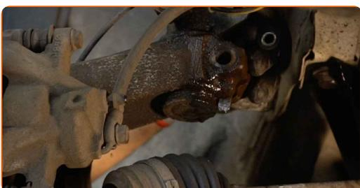
**40** Desligar a manga de eixo do suporte do amortecedor.
