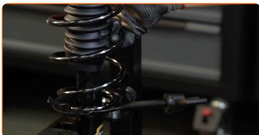
**57** Limpe os assentos de montagem da coluna do amortecedor. Use uma escova metálica. Use spray WD-40.
