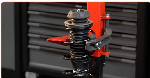
**56** Retire a coluna de suspensão montada.
