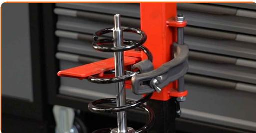
**52** Instale o apoio, o fole e o batente no amortecedor.
