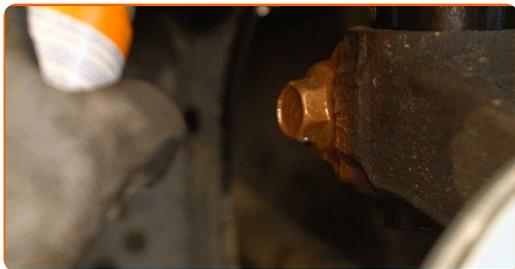
**79** Trate a superfície onde o disco de travão entra em contacto com o aro da roda. Use massa de cobre.
