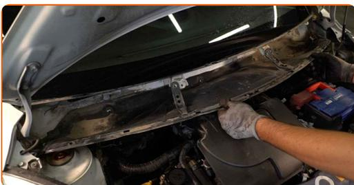
**87** Aparafuse os fixadores do painel da ligação das escovas do limpa-para-brisas. Use uma chave soquete nº 10. Use uma chave de catraca.
