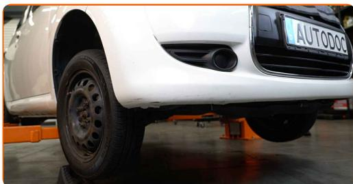
**18** Desaperte os parafusos da roda.
