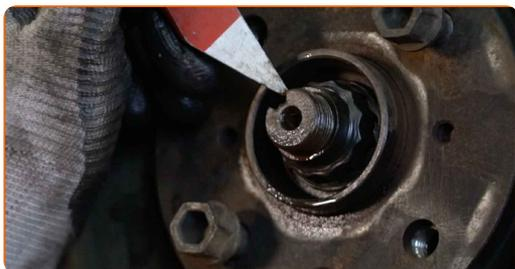
**78** Trate os fixadores do amortecedor. Use massa de cobre.
