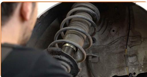
**43** Coloque o suporte do amortecedor sobre a ferramenta de compressão da mola.
