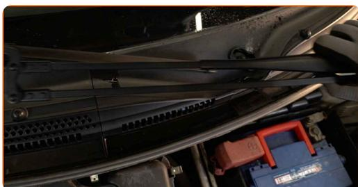
**7** Instale os pinos de fixação da cobertura de proteção das escovas. Use uma ferramenta de remoção de clipe.
