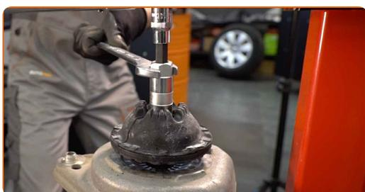
Substituição: kit de suspensão – Audi A6 4F2. Conselho da AUTODOC:
