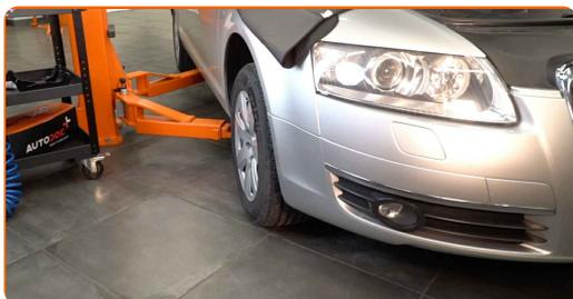
**69** Aperte a fixação superior da montagem do suporte do amortecedor. Use uma chave soquete nº 15. Use uma chave de torque. Aperte-o para o torque de 50 Nm.+90°
