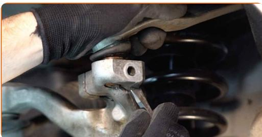
**58** Instale o parafuso de fixação.
