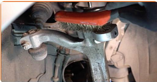
**55** Solte o elemento fixador que liga a junta esférica do braço de suspensão à manga do eixo. Use um cinzel plano para metal. Use um martelo.
