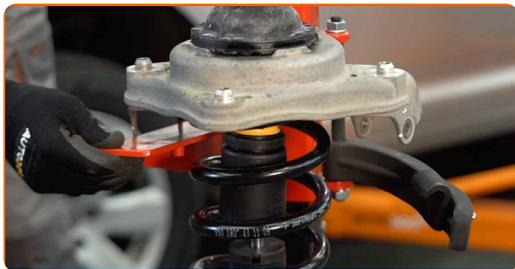
**44** Retire a coluna de suspensão montada.
