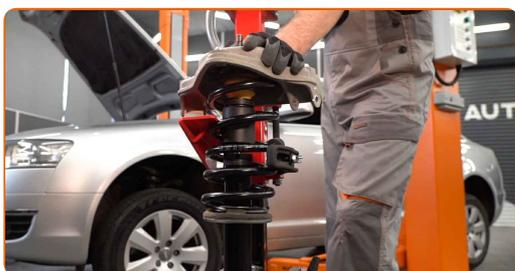
**42** Aperte a porca do suporte do amortecedor da haste do pistão. Use HEX n.º H6. Use uma chave soquete n.º 21. Use uma chave de torque. Aperte-o para o torque de 50 Nm.
