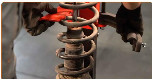
**35** Retire a mola. Remova a tampa protetora contra poeira do amortecedor e o para-choques.
