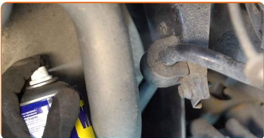
**9** Desaperte os fixadores dos suportes da bucha da barra estabilizadora. Use uma chave combinada nº 15. Use uma chave soquete nº 15.
