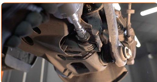
**8** Limpe os fixadores dos suportes da bucha da barra estabilizadora. Use uma escova metálica. Use spray WD-40.
