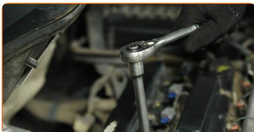
**8** Retire as velas de ignição. Use o soquete da vela de ignição #16.
