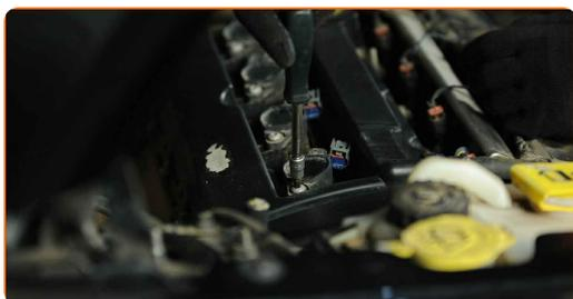
**5** Retire as bobinas de ignição dos poços das velas de ignição.
