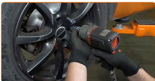
**25** Baixar o carro e trabalhar em ordem transversal, apertar os parafusos das rodas. Use o soquete de impacto para roda #17. Use uma chave de torque. Aperte-o para o torque de 100 Nm.
