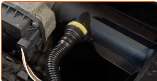
**27** Instale as mangueiras de ventilação do cárter.
