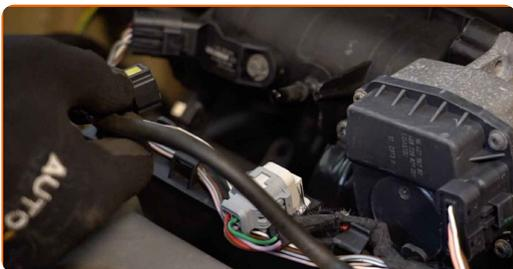
**4** Desconecte a mangueira de ventilação do cárter do coletor de admissão.
