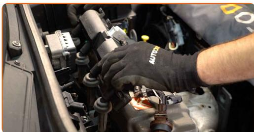
**13** Limpe a sujidade, poeira e detritos de dentro dos poços das velas de ignição.
