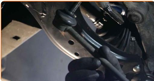
**Substituição: tirante da barra estabilizadora – CITROËN Berlingo II Van (B9).**
