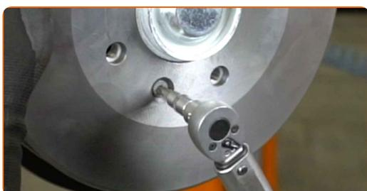
**18** Trate da superfície onde a jante da roda entra em contacto com o tambor de travão. Utilize massa lubrificante de cerâmica.
