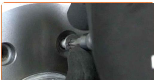
**17** Aperte os parafusos do tambor de travão. Use Torx T30. Use uma chave de torque. Aperte-o para o torque de 10 Nm.
