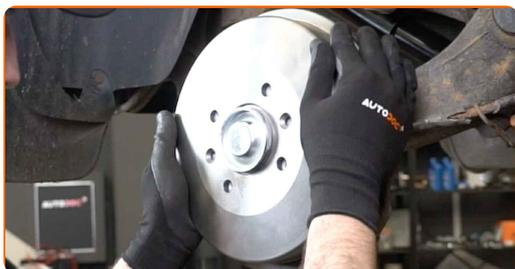
**16** Instale os parafusos de fixação.
