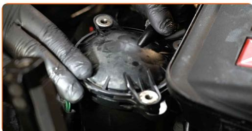
**11** Aperte os fixadores da capa da carcaça do filtro de combustível. Use HEX n.º H4. Use uma chave de torque. Aperte-o para o torque de 9 Nm.
