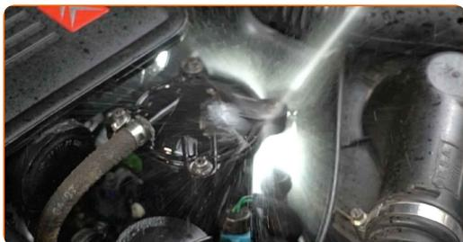
**4** Desenrosque os parafusos da tampa do filtro de combustível. Use HEX n.º H4. Use uma chave de catraca.
