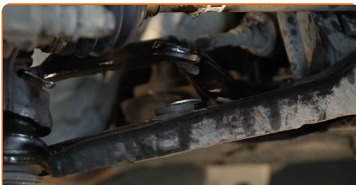
**Substituição: tirante da barra estabilizadora – CITROËN C1 II (PA, PS).**
