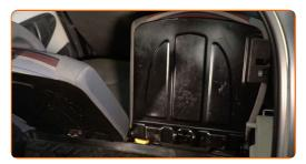
Remova os grampos do forro lateral do porta-malas. Use uma ferramenta de remoção de clipe.
