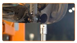
Desaperte a fixação inferior do amortecedor. Use uma chave soquete nº 14.
