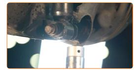
Aperte a fixação inferior do amortecedor. Use uma chave soquete nº 14. Use uma chave de torque. Aperte-o para o torque de 48 Nm.
