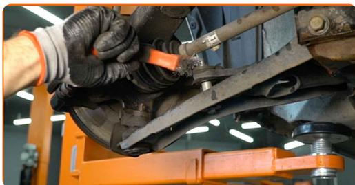
**32** Desaparafuse o fixador que conecta a barra estabilizadora ao braço. Use uma chave combinada nº 12. Use uma chave soquete nº 12. Use uma chave de catraca.
