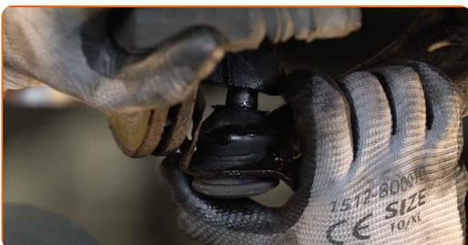
**66** Aperte o fixador da articulação esférica. Use uma chave combinada nº 19. Use uma chave de torque. Aperte-o para o torque de 98 Nm.
