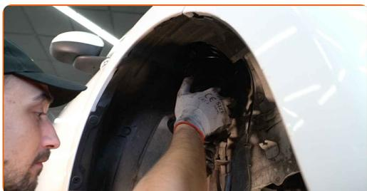
**59** Aparafuse a fixação superior de montagem do suporte do amortecedor. Não o aperte.
