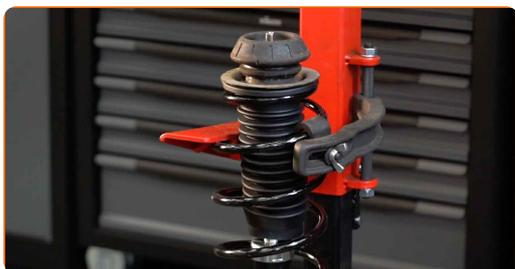
**56** Retire a coluna de suspensão montada.
