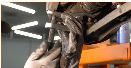
**31** Limpe os elementos de fixação de conexão do estabilizador. Use uma escova metálica. Use spray WD-40.
