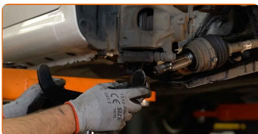
**38** Remova o parafuso de fixação.
