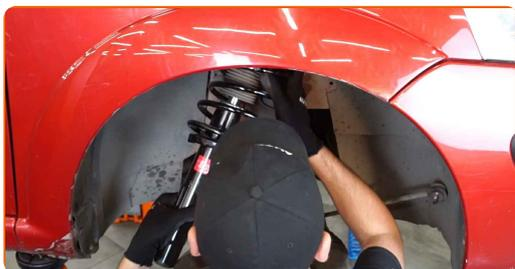
**45** Importante! Segure a roda enquanto enrosca os parafusos de fixação. CITROËN C2 Hatchback (JM) Não o aperte.
