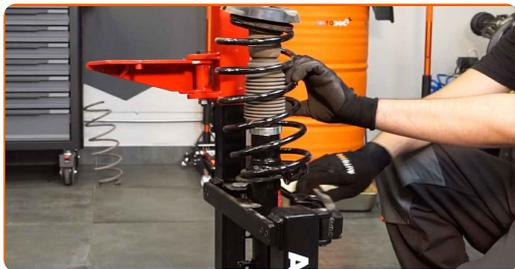
**44** Instale o amortecedor no arco da roda.
