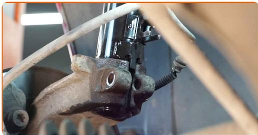
**48** Instale o parafuso de fixação.
