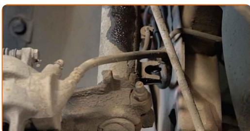
**15** Desaparafuse o fixador que conecta a bieleta da barra estabilizadora à coluna do amortecedor. Use uma chave combinada nº 17. Use Torx T30. Use uma chave de catraca.
