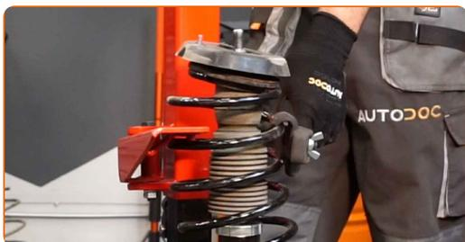
**43** Retire a coluna de suspensão montada.
