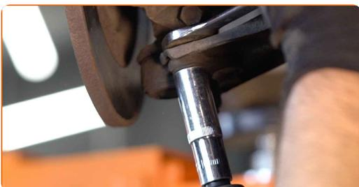
**55** Instale o terminal do estabilizador transversal.
