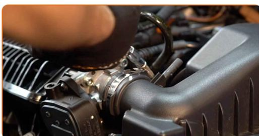
**5** Desapertar os parafusos de fixação da caixa do filtro. Use uma chave soquete nº 10. Use uma chave de catraca.
