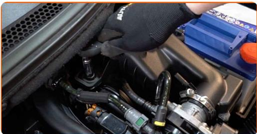
**6** Desconecte o tubo de entrada de ar do compartimento do filtro de ar.
