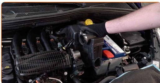
**16** Apertar os parafusos de fixação da caixa do filtro. Use uma chave soquete nº 10. Use uma chave de catraca.
