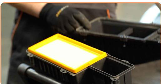
**10** Remova o elemento de filtro a partir da caixa do filtro.
