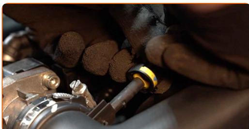
**4** Desparafuse o grampo que prende a carcaça do filtro de ar do motor ao corpo do acelerador. Use uma chave soquete nº 7.
