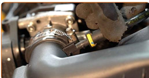
**19** Conecte o tubo de entrada de ar ao compartimento do filtro de ar.
