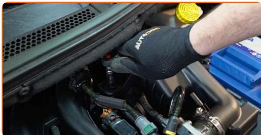
**17** Aperte o grampo que prende a carcaça do filtro de ar do motor ao corpo do acelerador. Use uma chave soquete nº 7.
