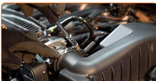
**18** Ligue a mangueira de ventilação do cárter ao tubo de ventilação.
