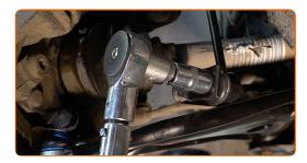
Desaparafuse o fixador que conecta bieleta da barra estabilizadora à barra estabilizadora. Use uma chave soquete nº 16. Use uma chave de torque. Aperte-o para o torque de 43 Nm.
