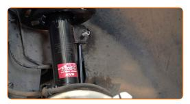
Aperte o fixador que conecta a bieleta da barra estabilizadora à barra estabilizadora. Use uma chave soquete nº 16. Use uma chave de torque. Aperte-o para o torque de 43 Nm.
