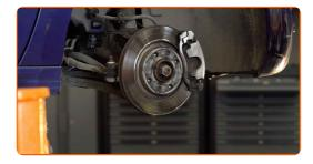
6.1 Limpe os elementos de fixação de conexão do estabilizador. Use uma escova metálica.
