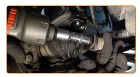
Desaparafuse o fixador que conecta a bieleta da barra estabilizadora à coluna do amortecedor. Use uma chave soquete nº 16.
