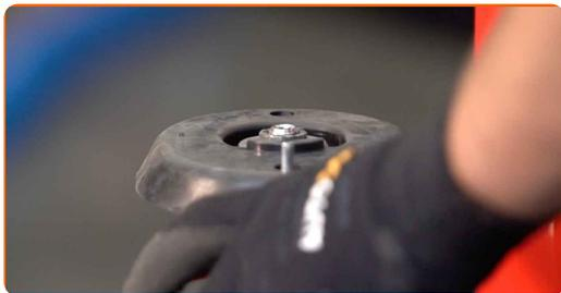
**41** Aperte a porca do suporte do amortecedor da haste do pistão. Use HEX n.º H7. Use uma chave soquete n.º 19. Use uma chave de torque. Aperte-o para o torque de 60 Nm.
