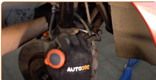
**59** Desaparafuse o fixador que conecta bieleta da barra estabilizadora à barra estabilizadora. Use uma chave soquete nº 17. Use uma chave de torque. Aperte-o para o torque de 35 Nm.
