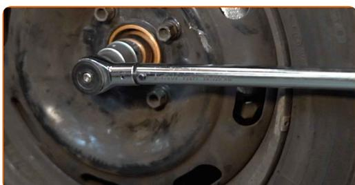
**70** Apertar os parafusos da roda usando um padrão cruzado. Use uma chave de torque. Aperte-o para o torque de 90 Nm.
