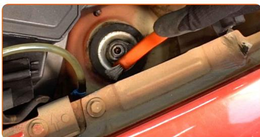
**4** Solte o fixador superior do apoio da coluna de suspensão. Use HEX n.º H7. Use uma chave combinada n.º 22. Use uma chave de catraca.
