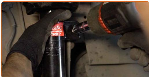
**57** Fixe a mangueira de travão na barra de suporte. Conecte a fixação do cabo do sensor ABS ao suporte do amortecedor.
