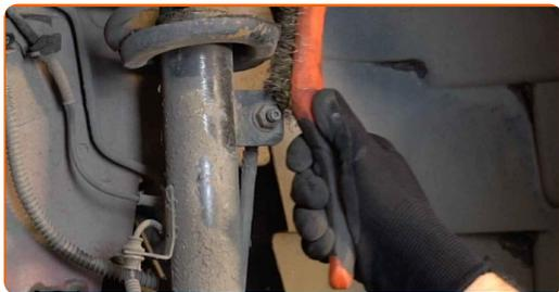
**14** Desligue a instalação elétrica e a mangueira do travão do braço de suporte do amortecedor. Utilize um pé-de-cabra.
