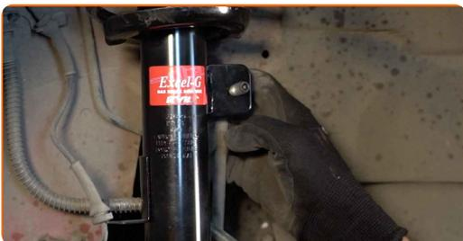
**56** Aperte o fixador da bieleta da barra estabilizadora. Use uma chave soquete nº 17.
