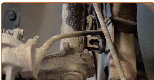
**15** Desparafuse o fixador que conecta a bieleta da barra estabilizadora à coluna do amortecedor. Use uma chave combinada nº 17. Use Torx T30. Use uma chave de catraca.
