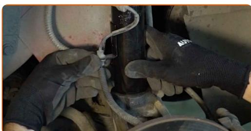
**58** Aperte os fixadores inferiores que conectam a coluna de suspensão à manga de eixo. Use uma chave soquete nº 16. Use uma chave de torque. Aperte-o para o torque de 59 Nm.
