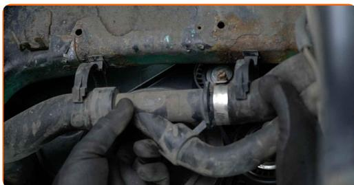
**11** Limpe o parafuso da polia de tensão. Use uma escova metálica.
