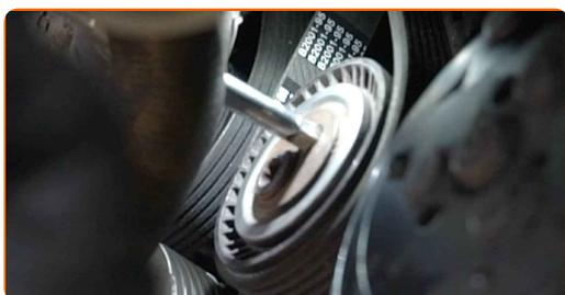
Substituição: correia trapezoidal estriada – CITROËN C3 Pluriel. Conselho:
