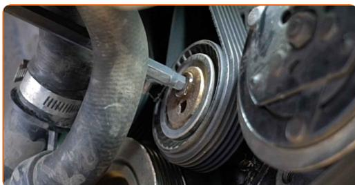
**13** Puxe para o lado a polia do tensor da correia trapezoidal estriada. Use uma barra de extensão para chaves de caixa de 1/4". Use uma chave de catraca.
