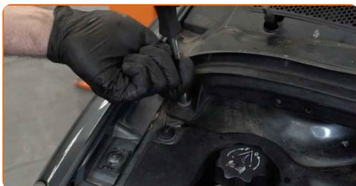
**74** Instale os fixadores da carenagem da grelha de plástico do limpador para-brisas.
