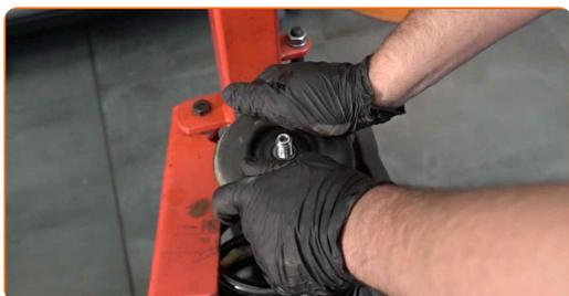
**44** Aperte a porca do suporte do amortecedor da haste do pistão. Use uma chave soquete nº 18. Use HEX n.º H7. Use uma chave de torque. Aperte-o para o torque de 69 Nm.
