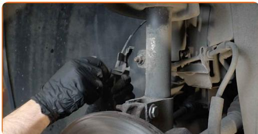
**21** Limpe os elementos de fixação de conexão do estabilizador. Use uma escova metálica. Use spray WD-40.
