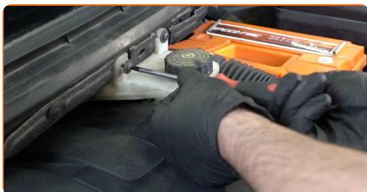
**7** Remova os grampos da grelha da estrutura de plástico. Use uma ferramenta de remoção de clipe.
