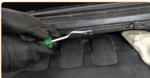
**8** Desenrosque os fixadores da grelha do para-brisas. Use uma chave soquete nº 10. Use uma chave de catraca.
