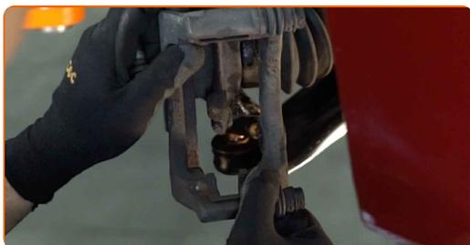
**15** Limpe os elementos de fixação do disco de travão. Use uma escova metálica. Use spray WD-40.
