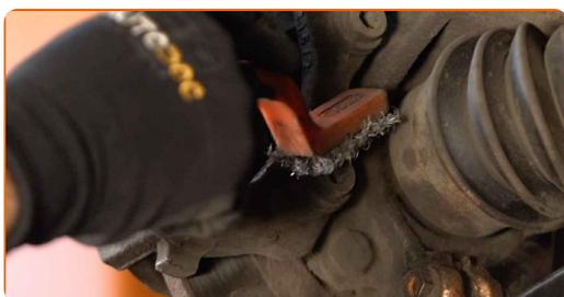
**13** Desaperte a fixação da braçadeira da pinça. Use Torx T55. Use uma chave de tarraxa.
