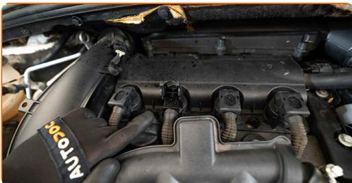
4 Desconecte o conector da bobina de ignição.
