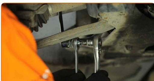
**13** Desaparafuse o fixador que conecta bieleta da barra estabilizadora à barra estabilizadora. Use uma chave combinada nº 19. Use HEX n.º H6. Use uma chave de torque. Aperte-o para o torque de 65 Nm.
