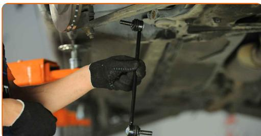
**12** Aperte o fixador que conecta a bieleta da barra estabilizadora à barra estabilizadora. Use uma chave combinada nº 19. Use HEX n.º H6. Use uma chave de torque. Aperte-o para o torque de 65 Nm.
