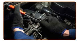
Desaperte os parafusos de fixação da tampa do filtro de ar. Use a chave Phillips.
