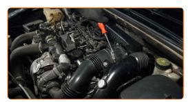
Remova o conjunto da caixa de distribuição de ar. Use uma chave de fenda plana.
