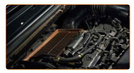
Remova o elemento de filtro a partir da caixa do filtro.
