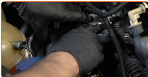
**15** Instale os parafusos de fixação.
