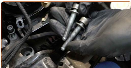
**12** Limpe o assento de montagem do apoio do motor. Use uma escova metálica. Use spray WD-40.
