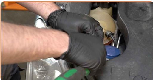
**4** Remova a tampa do depósito do líquido de refrigeração.
