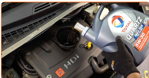
Substituição: óleo do motor e filtro – CITROËN C5 III Carrinha (RW\_).
