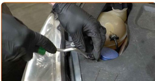
**12** Remova a cobertura de proteção do reservatório de líquido de refrigeração.
