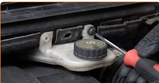
**9** Desenrosque os fixadores da grelha do para-brisa. Use uma chave soquete nº 10. Use uma chave de catraca.
